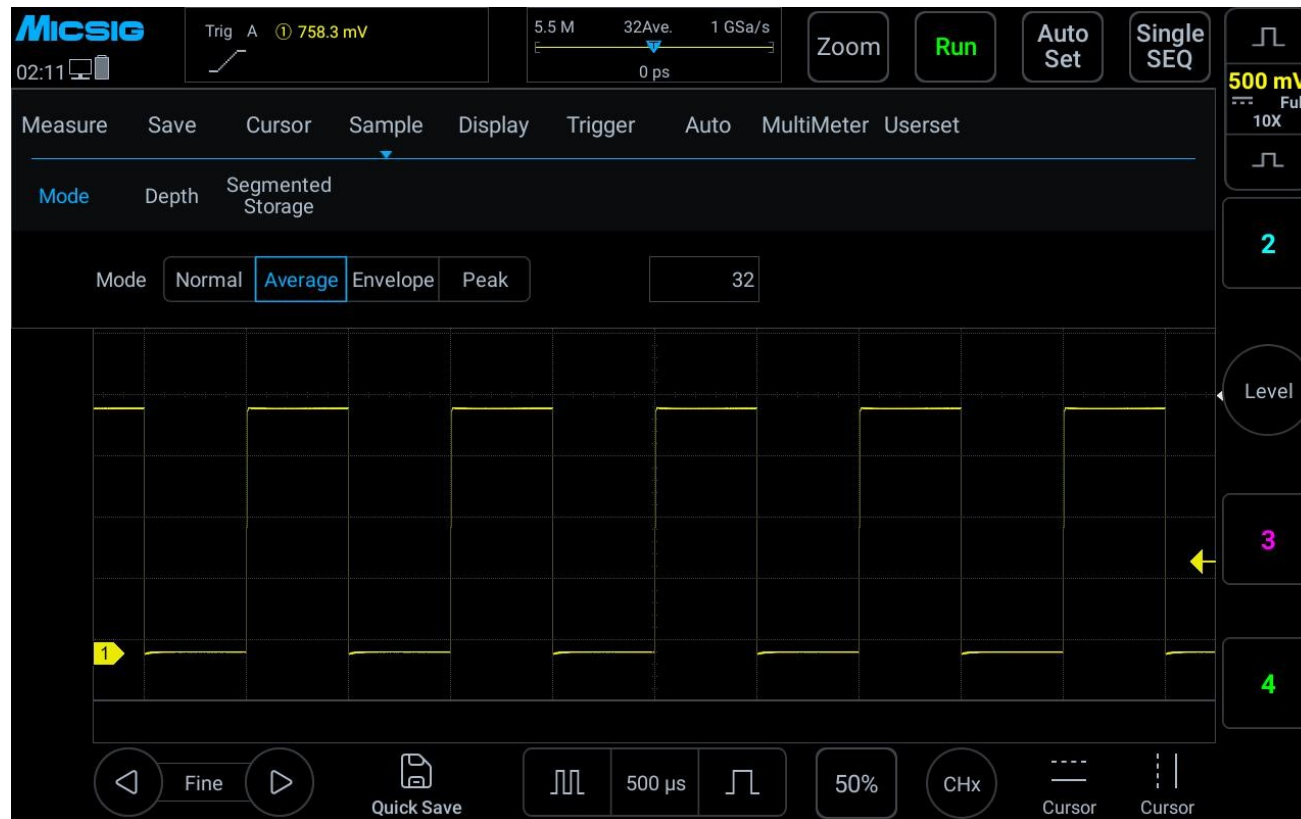
Abbildung 12-5 Die Wellenform nach Auswahl des Durchschnitts-Abtastmodus mit einer Durchschnittsanzahl von 16.
