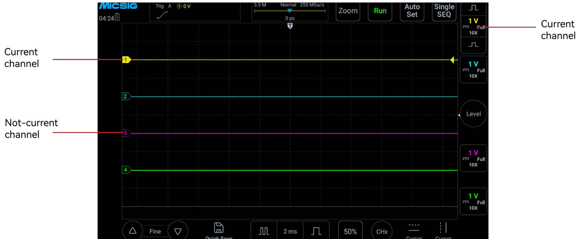
Abbildung 5-2 Stromkanal und Nicht-Stromkanal
